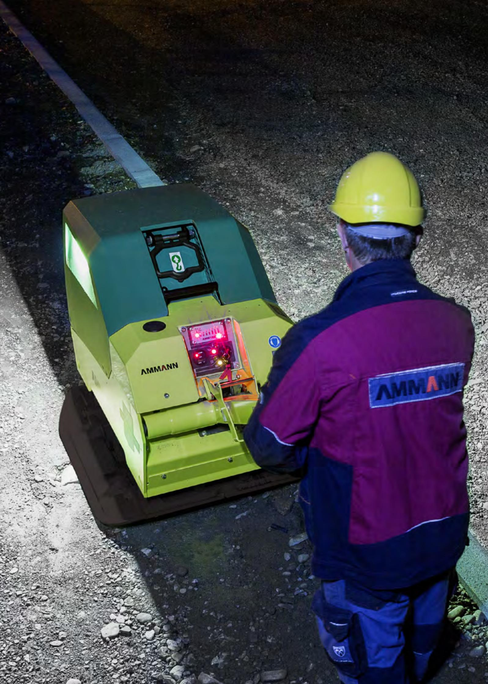
" El control remoto de la APH 1000 TC permite operarla desde un sitio seguro, sin peligro y sin vibraciones en el sistema mano-brazo para el operador".
