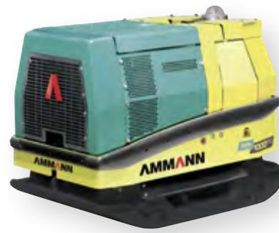
La APH 1000 TC es una plancha hidrostática teledirigida con IR que puede llegar donde otras no llegan. La capacidad remota infrarroja garantiza la operación bajo condiciones severas, y en los espacios más estrechos y las fosas más profundas. El operador puede controlar la plancha vibratoria desde una distancia segura con un control remoto o mando por cable.
